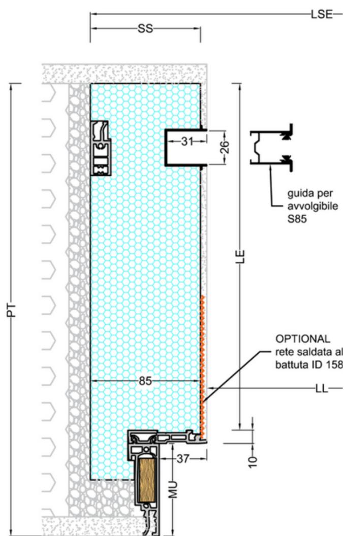
**F46 è il controtelaio con spalla coibentata in EPS 150** per finestra con avvolgibile quando il montaggio dell'infisso è a filo muro interno.
