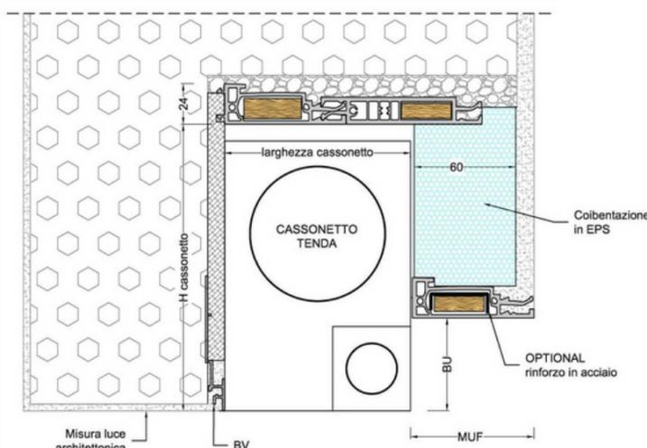
Permette l'alloggiamento **nel vano superiore di ogni tipo di tenda a rullo** assicurando **resistenza meccanica e isolamento termico**, senza limiti dimensionali, grazie alla possibilità di inserire **rinforzi metallici coibentati**.
