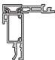
Profilo S155 Misura utile MU mm 55
